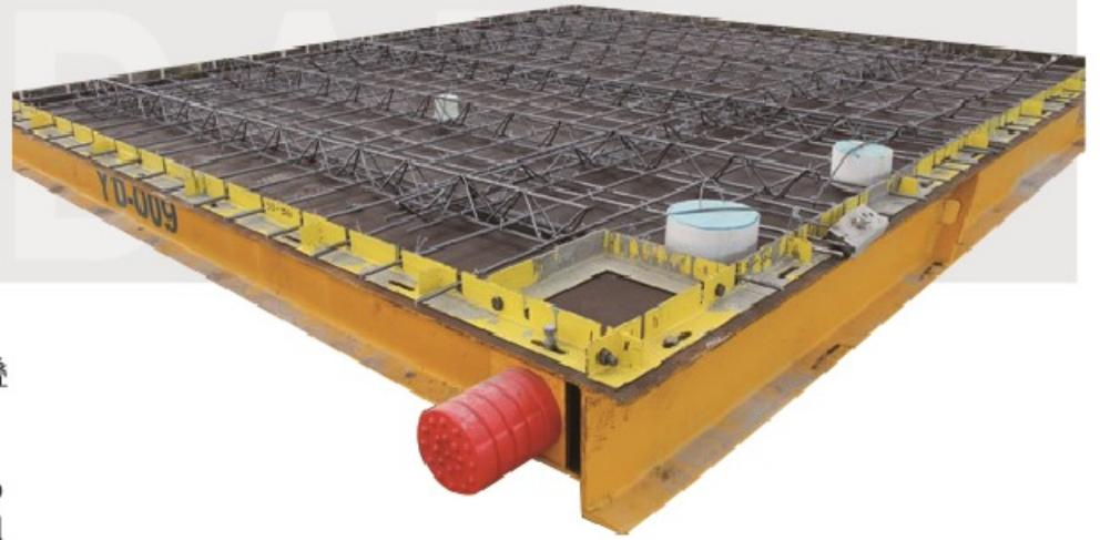
叠合板模具, 通常有焊板叠合板模具, 角钢叠合板模具两种。
